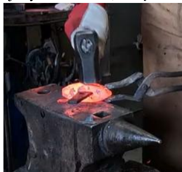
pav. 66. Skersinio formavimas ant geležtės šablono.
