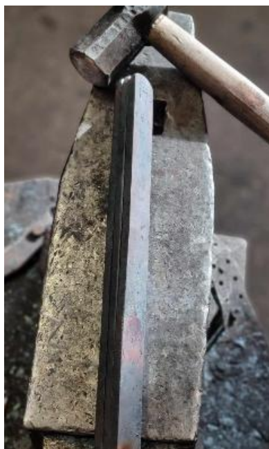
pav. 57. Trys metalo sluoksniai, formuojantys geležtės šerdį.
