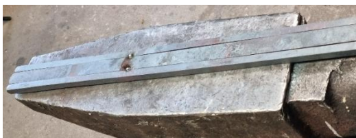
pav. 58. Ašmenų prijungimas prie suformuotos šerdies.
