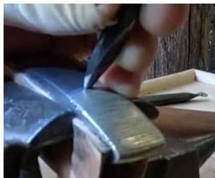
pav. 68. Ornamentavimo griovelio formavimas kalteliu.
